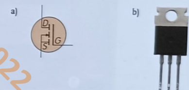
Rys. 12.14. Tranzystor polowy z izolowaną bramką i kanałem typu n: a) oznaczenie i symbol, b) wygląd typowego elementu
