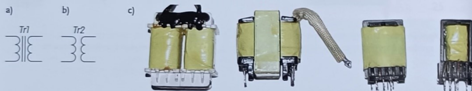
Rys. 12.9. Transformator: a) oznaczenie i symbol z rdzeniem Tr1, b) oznaczenie i symbol bez rdzenia Tr2, c) wygląd typowego elementu
